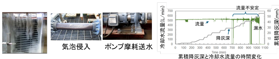
図 219 冷却塔の降灰実験状況（左）および累積降灰深と冷却水流量変化（右）
