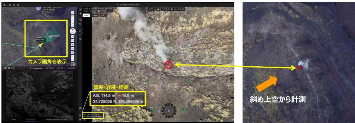
図15 レーザ測距による噴気位置の計測事例
