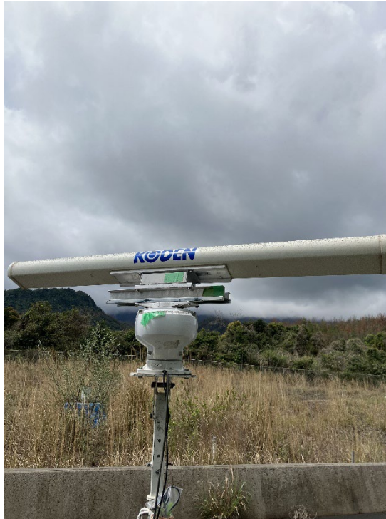
図 80 仰角 30° に設定された PPI 観測用レーダアンテナ
