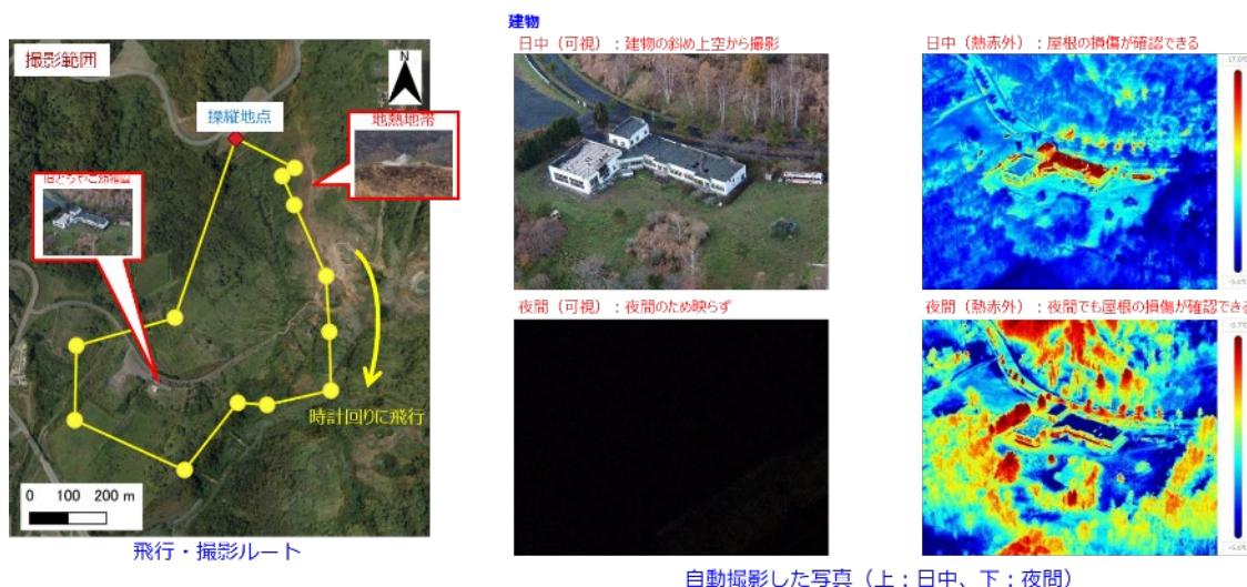
図 43 自律飛行・自動撮影による空中定点観測の実施例
