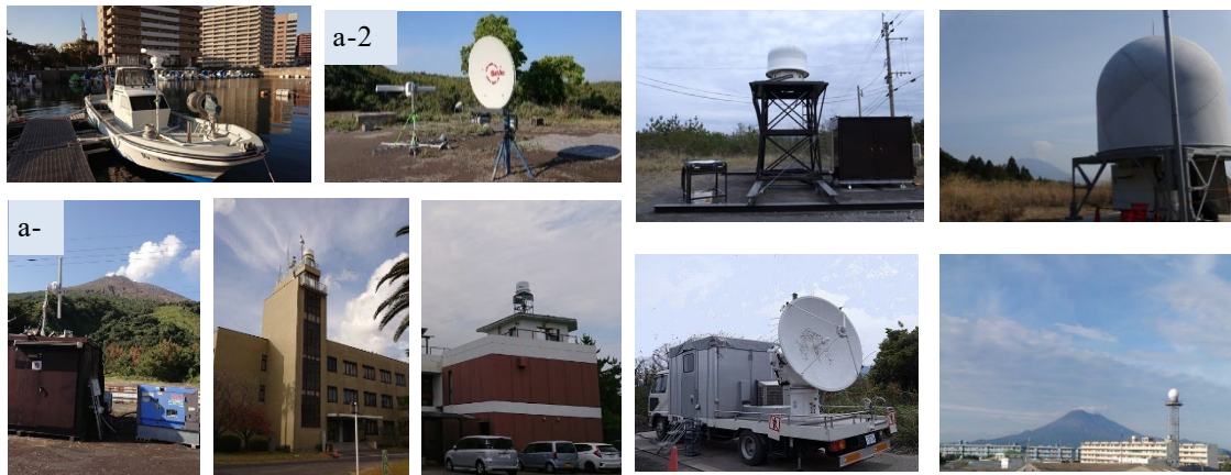
図 2-5 桜島の噴煙観測に用いられた様々なタイプの気象レーダ。
