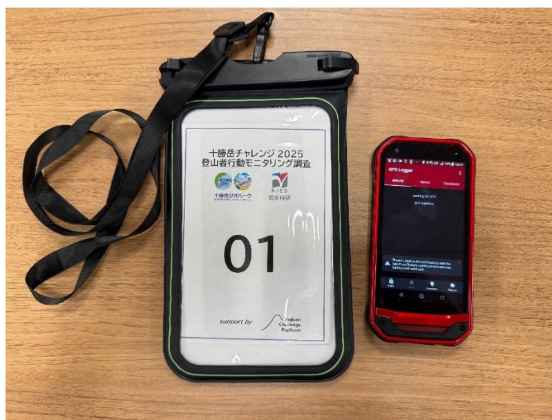
図 203 実験に使用した、GPS 計測アプリをインストールしたスマートフォンとケース
