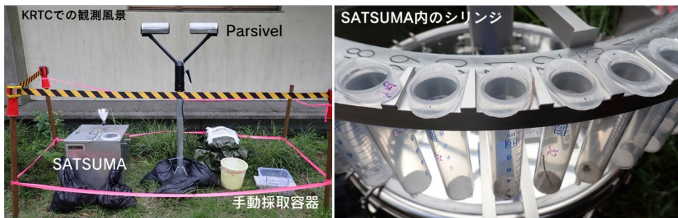
図 73 ディストロメータと SATSUMA の併置観測の様子。
