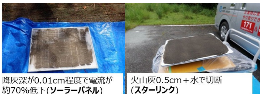
図 216 降灰実験の結果(左：ソーラーパネル 右：衛星通信機器)
