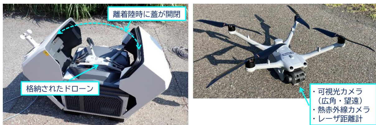
図13 使用機材（左：DJI Dock 3（ドローンドック）、右：DJI Matrice 4TD（機体））
