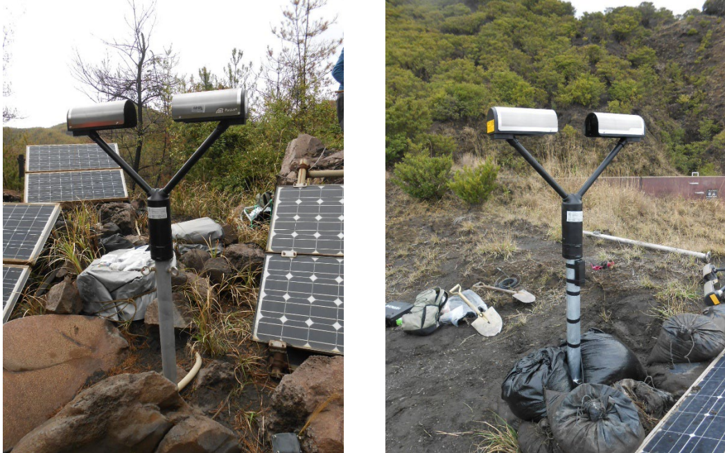
図 71 機器更新したディストロメータの設置状況の例（左：NAB、右：KIT）。
