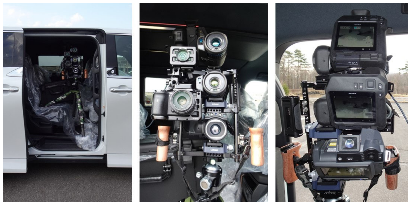
図 39 浅間山地上試験観測時の装置の設置状況。左図：装置をワゴン車内に三脚を 1 台用い設置し、スライドドアを開け観測実施。中右図： SPIC-UC フィールドタイプ赤外カメラ 1、SPIC-UC フィールドタイプ赤外カメラ 2、STIC-P 赤外カメラ、STIC-P 可視カメラ 1、2 を一つのフレームにまとめ、1 つの三脚に搭載できるようにした装置構成。
