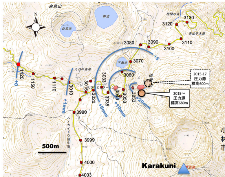
図 31 えびの高原～硫黄山区間の水準路線と2023年3月から2024年4月までの隆起量 (BM3040を除く)。2018年4月から活発化した噴気領域や、これまでの水準測量から推定された圧力源の水平位置も同時に示す。国土地理院電子地形図 (タイル) を使用した。
