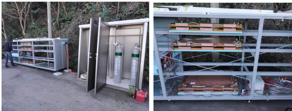
図4 桜島観測坑道上部における地殻変動観測用ミュオグラフィ測位基準装置の設置状況。
