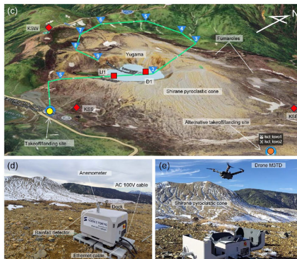
図A8. ドローンポートの設置状況と典型的な飛行ルート。標高2000mの冬山において、現地観察が困難な活発期を通じて、地熱活動域に変化が生じていないか等を、150km離れた東京などの遠隔地から、昼夜と問わずいつでも容易に確認できた。空中映像を、気象庁監視担当者や草津町役場とリアルタイム共有する試験、訓練も実施した。
