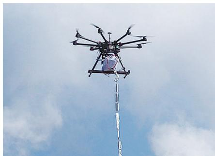
図2 ドローンを用いた噴煙採取の様子（2021年11月15日、阿蘇中岳）。ドローン直下の採取装置が噴煙を自動判別し、下方に伸びたチューブから噴煙を吸引・採取します。
