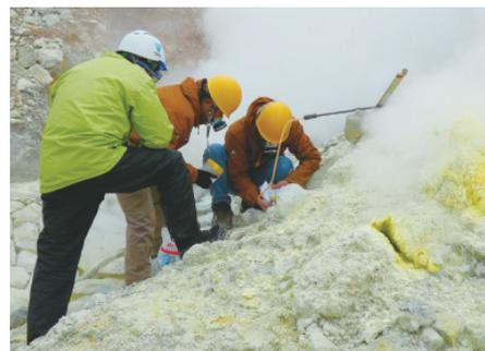
図3 箱根山における火山ガス採取の様子。黄色の物質は自然硫黄。火山ガスを毎月採取し、化学組成と同位体比を分析しています。
