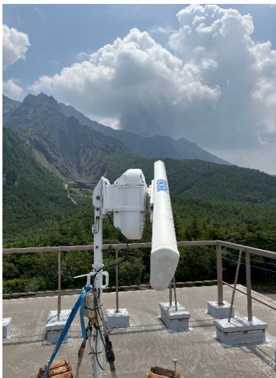
図 24 ハルタ山に設置した固体化船舶レーダ
