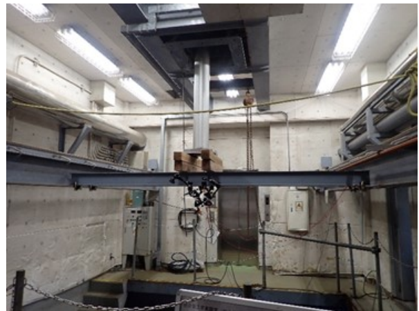
図 58. 縦型実験装置のホーニング管と速度計測機構
