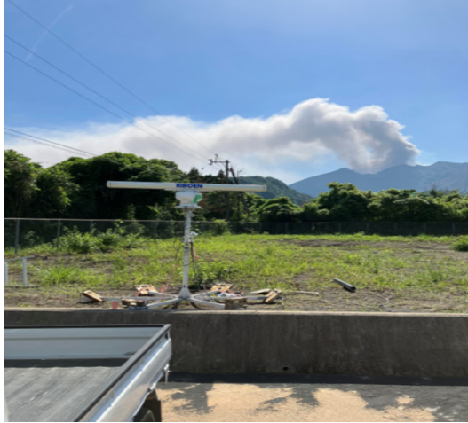
図 28 黒神観測室における固体化船舶レーダ（SSR100W）の設置風景（2024 年 5 月 14 日）。
