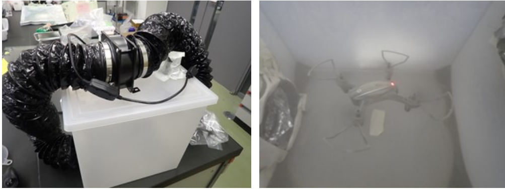
図 16. ミニドローンへの火山灰の影響実験（左：実験装置、右：容器内の様子）
