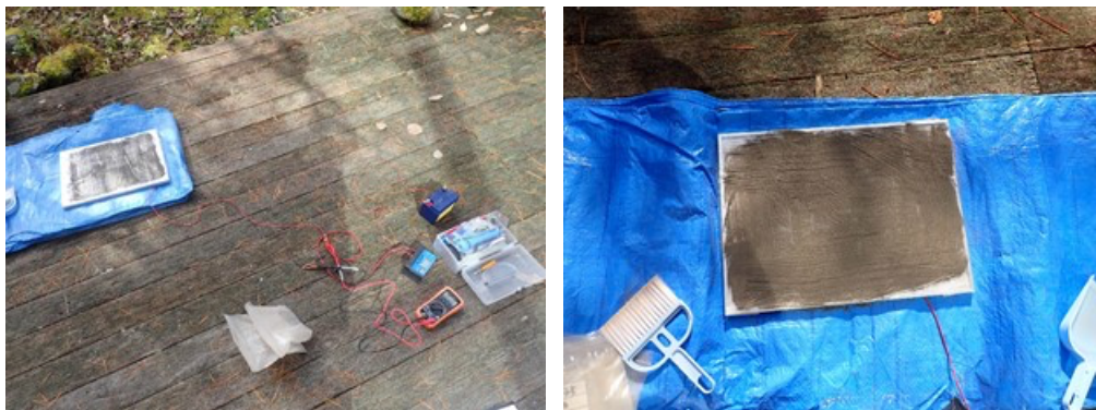
図 15. ソーラーパネルへの火山灰の影響実験（左：実験の様子、右：降灰深 0.05cm の様子）
