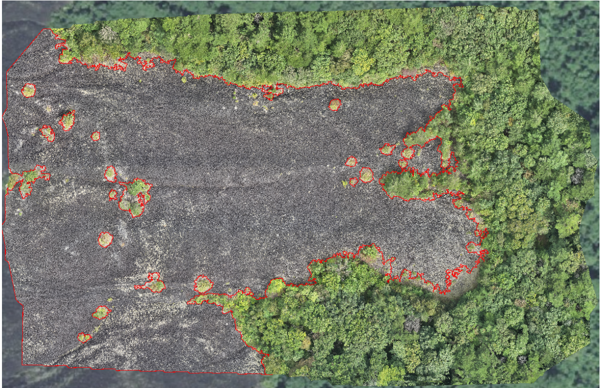
図 20 溶岩流の境界を自動抽出した例
