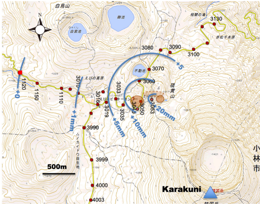
図 33 えびの高原～硫黄山区間の水準路線と 2023 年 3 月から 2024 年 4 月までの隆起量（BM3040 を除く）。2018 年 4 月から活発化した噴気領域や、これまでの水準測量から推定された圧力源の水平位置も同時に示す。国土地理院電子地形図（タイル）を使用した。
