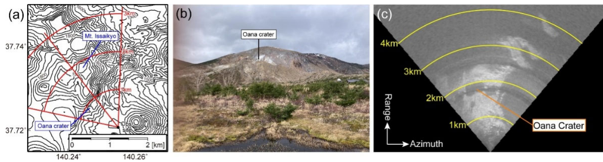
図 1-1 (a)SCOPE による大穴火口（吾妻山）の観測場所周辺地図。(b)観測地点からの風景。(c) SCOPE の計測から得られた散乱強度画像。
