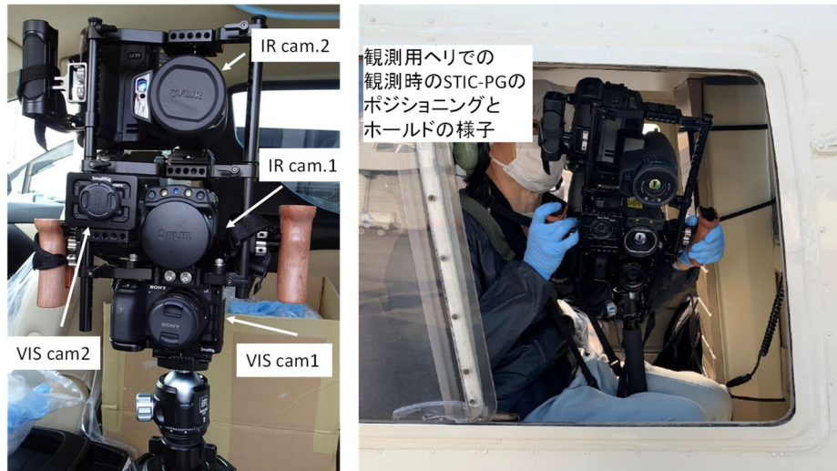
図 2-6 STIC-PG の外観写真(上図左)とヘリ搭載時の機材の設置状況 (上図右)
