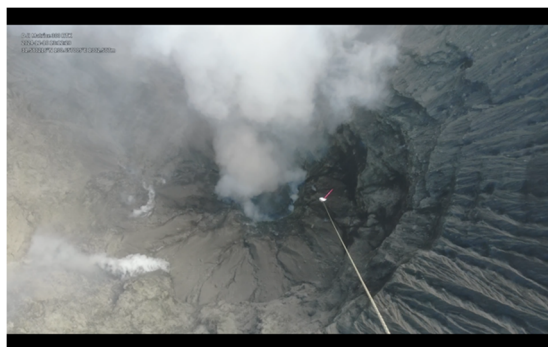
図 9 桜島南岳火口内における Se1PS を用いた噴煙採取の様子。ドローン本体に取り付けられたカメラから直下を撮影したもので、画面中央付近に長さ 30 メートルのワイヤーに吊り下げられている Se1PS が見える。
