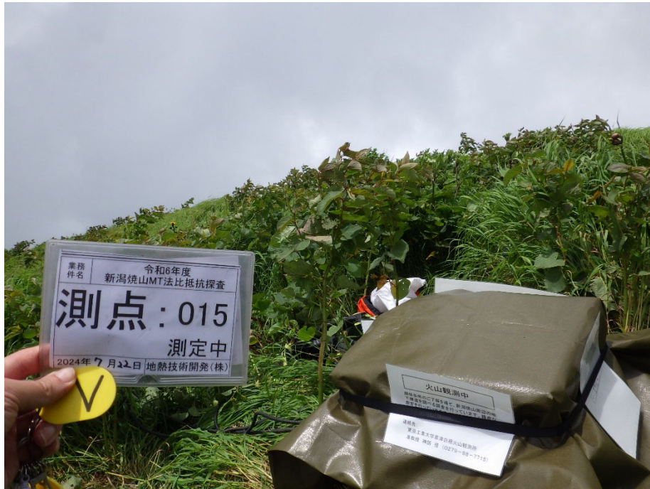
図 25. 焼山山頂から東に約 1.9 km 離れた影火打山西の観測点 (NYK015) における測定の様子。測定装置やバッテリーを入れたケースを深緑色のビニールシートで覆っている。測定装置には、磁場センサーおよび電極に繋がるケーブルが接続されている。連絡先等を記した「火山観測中」の札と自然公園法ならびに国有林使用の許可書類を掲示している。
