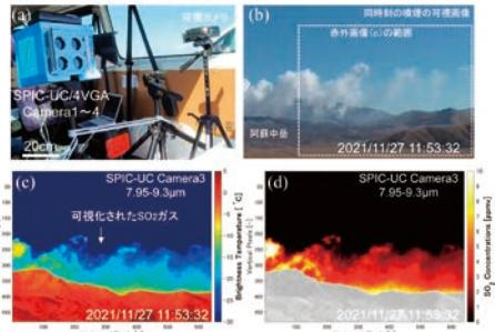
図2 (a) 温度とガスを可視化するカメラ：SPIC-UC/4VGA (赤外波長域の4つの波長帯域を計測する4台の赤外カメラ：Camera1～4で構成) 設置の様子 (阿蘇中岳噴煙試験観測：2021/11/27、草千里展望所より)。
