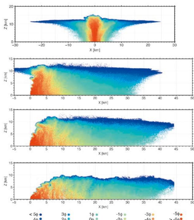
図1 富士山1707年宝永噴火に相当する噴火規模の数値シミュレーション結果。上から風速が0、10、20、30 m/sと変えた場合について、(左列) 噴煙濃度分布と(右列) 火山灰粒子分布を示す。右列の色の違いは火山灰粒子の粒径を表す。
