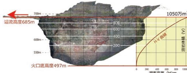
図2 ドローンによる伊豆大島計測（左：3次元モデル、右：三原山火口メスシリンドラー表現）
