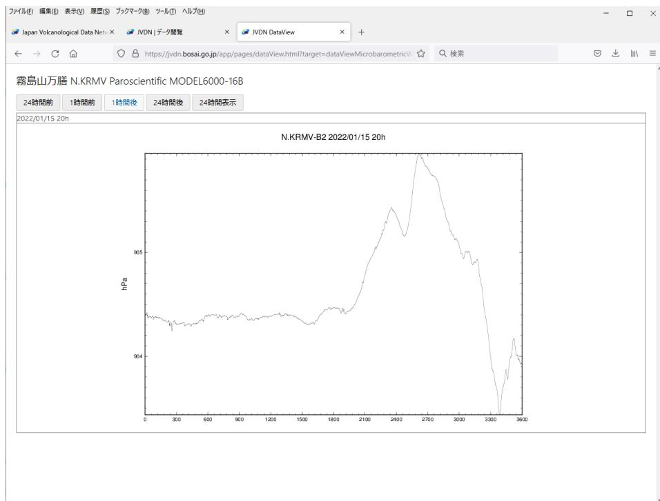
本年度新たに JVDN システムが対応した微気圧計データ。表示しているデータは、令和 4 年 1 月 15 日にトンガで発生した大規模噴火による霧島山万膳火山観測施設での気圧変化。
