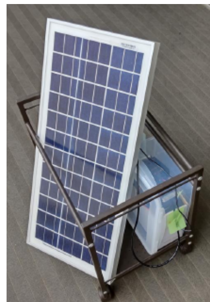
図 15 (株)mss 製の粒子数計測器。太陽電池パネルと LTE 通信により任意の場所に設置が可能。
