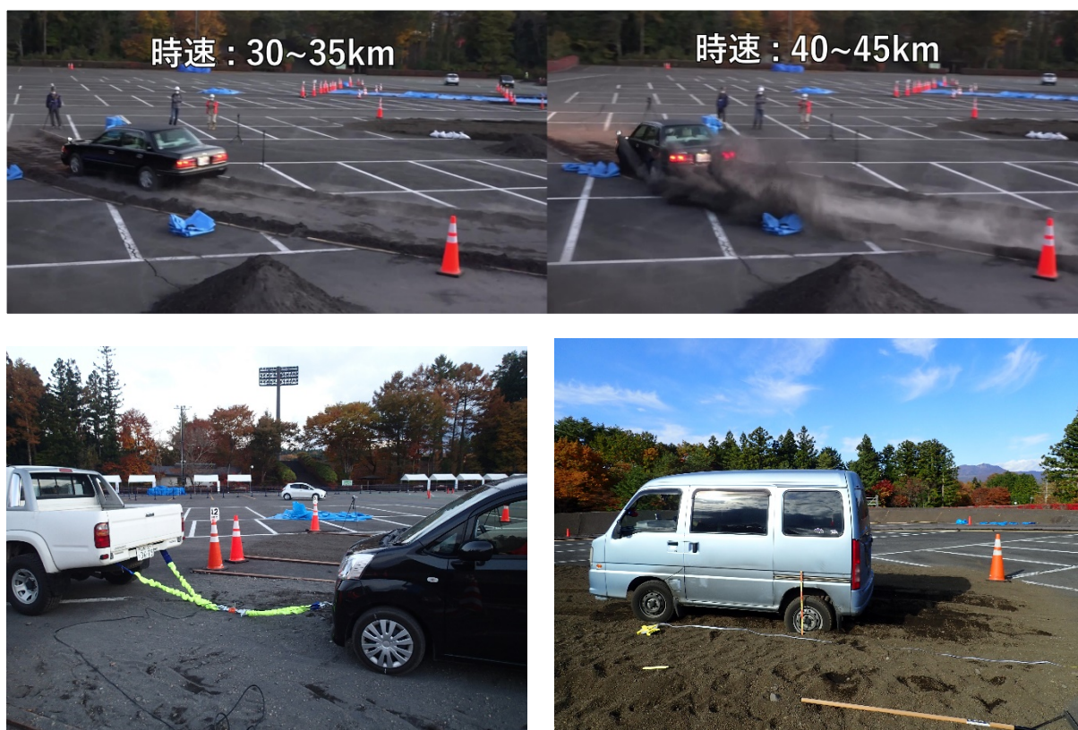
写真 1 富士山麓で実施された火山灰上走行実験。（上）カーブコースでの侵入速度の違い。（左下）牽引試験の様子。（右下）スコリア 30 cm コースにおけるスタック状態。
