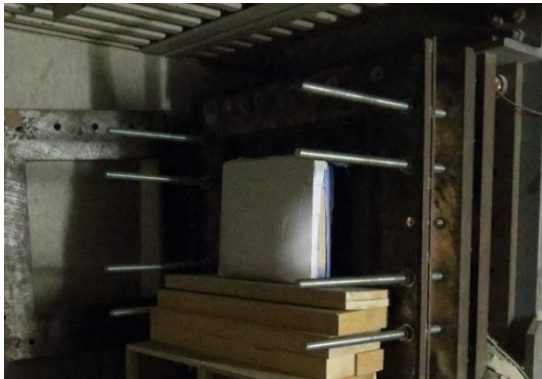
写真10 砂を置いた実験（砂 13.8cm、飛翔体速度 55.6m/s）の前（左）と実験後（右）
