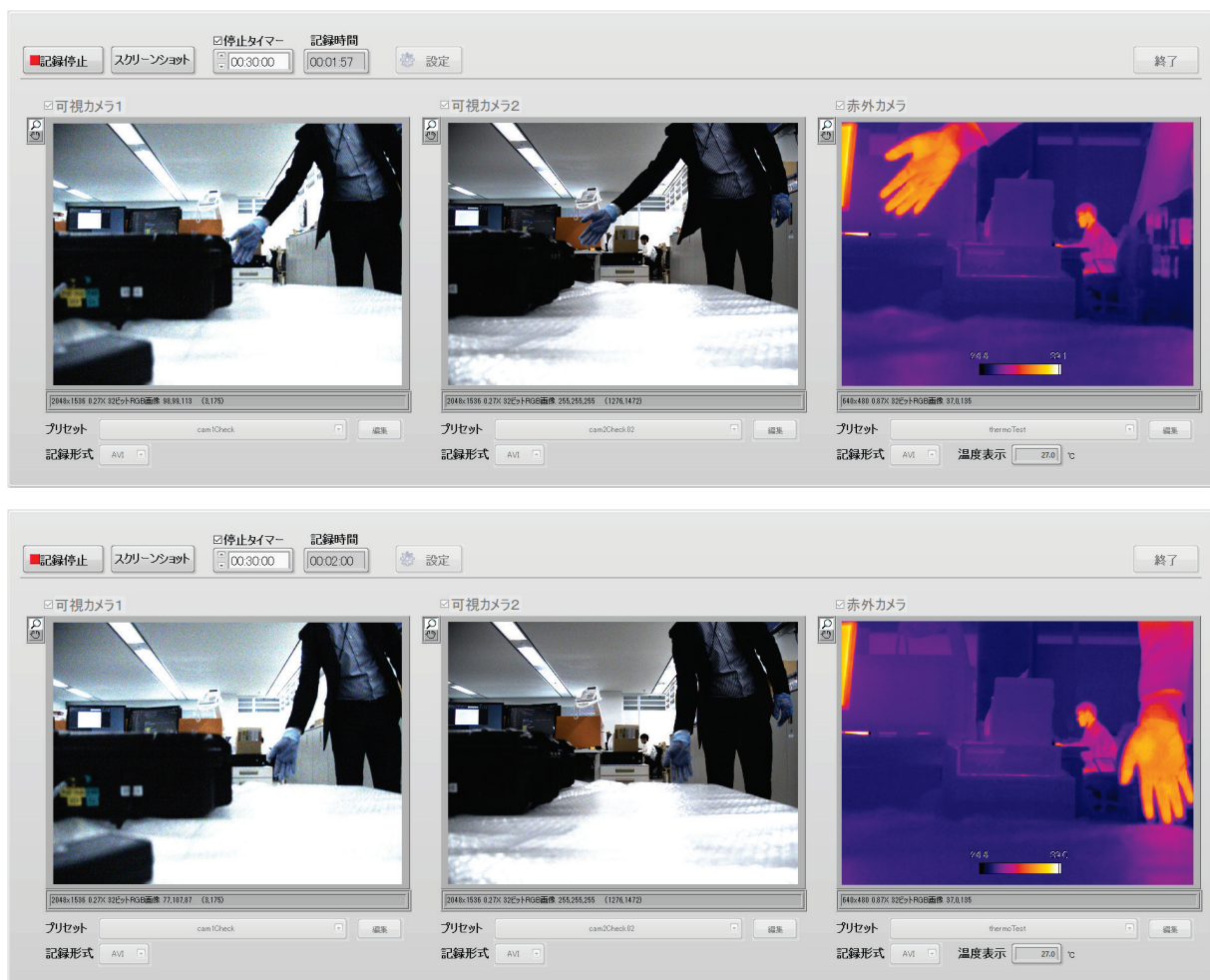
図 2-14 SPIC-SS フィールドタイプ（温度・地形計測）の試験計測画像（3 秒間隔の 3 台のカメラ同期画像の例）
