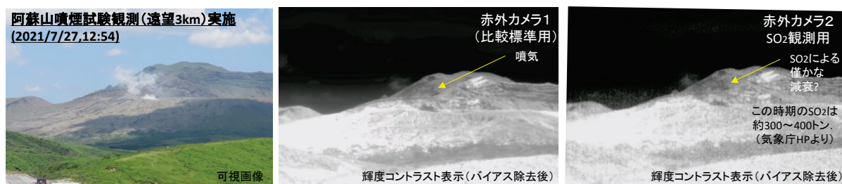
図2-16 SPIC-UC(4QVGA)の阿蘇山中岳の観測結果（異なる赤外バンドで計測したデータの輝度コントラスト補正画像。大気補正は未補正。2021年7月27日12時54分。）阿蘇山中岳の西方3.15kmの草千里展望所より観測。明確なSO 2 検出データの取得は未達
