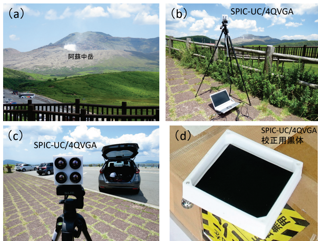
図2-15 SPIC-UC(4QVGA)のフィールドでの観測の様子（阿蘇山中岳の噴煙観測、2021年7月27日）。阿蘇山中岳の西方3.15kmの草千里展望所より観測
