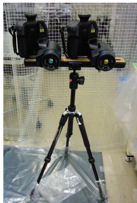
図 2-11 SPIC-UC フィールドタイプ（近接温度・ガス計測）の完成写真
