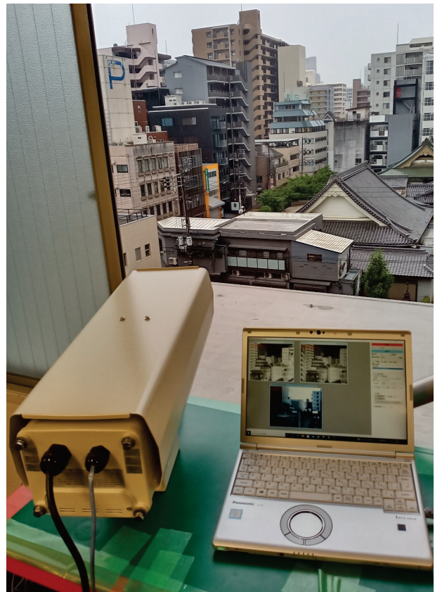
図 2-4 完成した非冷却型赤外カメラ (SPIC-UC) フィールドタイプ (定点観測タイプ (温度・ガス計測)) の写真と、開発したソフトにより試験計測を実施した際の写真
