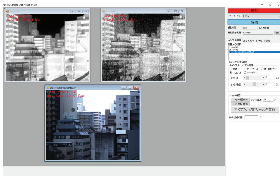
図 2-5 非冷却型赤外カメラ (SPIC-UC) フィールドタイプ (定点観測タイプ (温度・ガス計測)) の制御記録 Viewer ソフトのスクリーンショット
