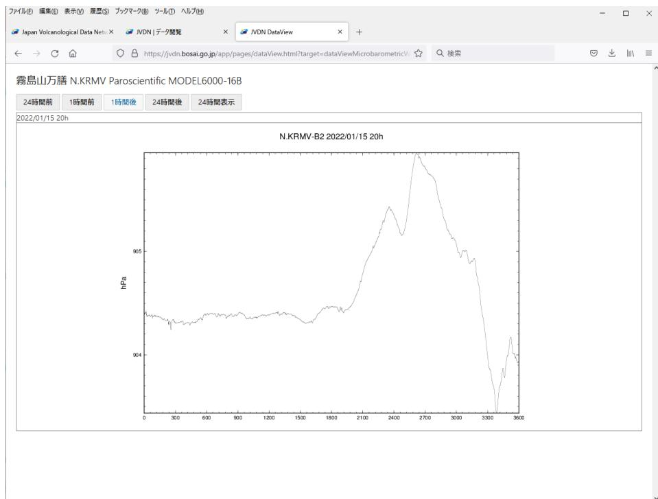
本年度新たに JVDN システムが対応した微気圧計データ。表示しているデータは、令和 4 年 1 月 15 日にトンガで発生した大規模噴火による霧島山万膳火山観測施設での気圧変化。
