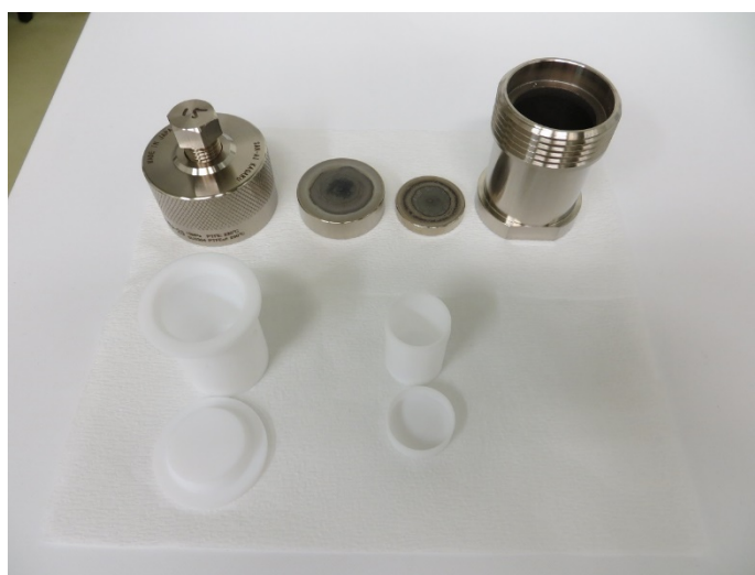
図 103. 加圧酸分解法に使用した加圧容器、および内部のテフロン容器。
