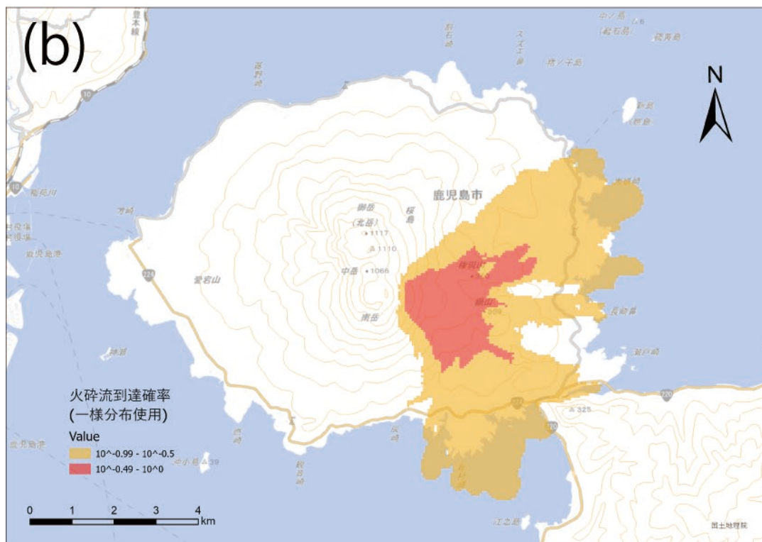
図 2 6 火砕流の到達確率を示す確率論的ハザードマップ。噴火規模 M の頻度分布 N(M) に経験的べき乗則( \log_{10} N \propto -0.75M^{10} )を与えた場合(a)と単純な一様分布( N = \text{const} )を与えた場合(b)。
