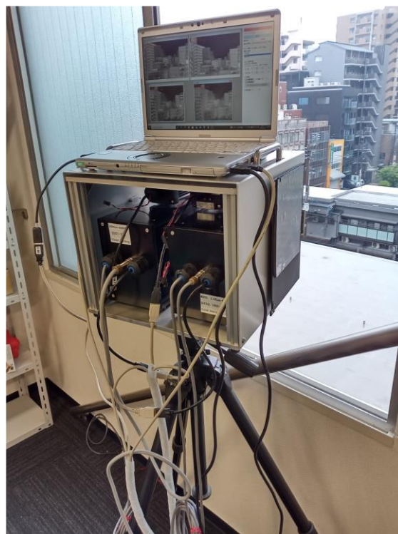
図 2-8 冷却型赤外カメラ（SPIC-C）フィールドタイプ（MWIR/LWIR）の完成写真と試験計測の様子
