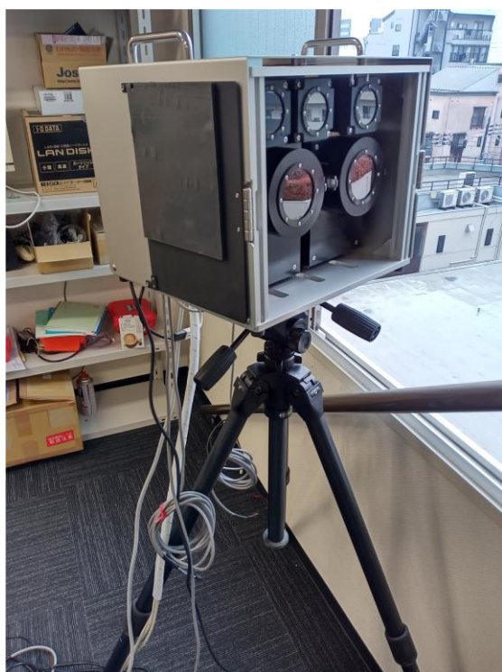
図 2-8 冷却型赤外カメラ（SPIC-C）フィールドタイプ（MWIR/LWIR）の完成写真と試験計測の様子
