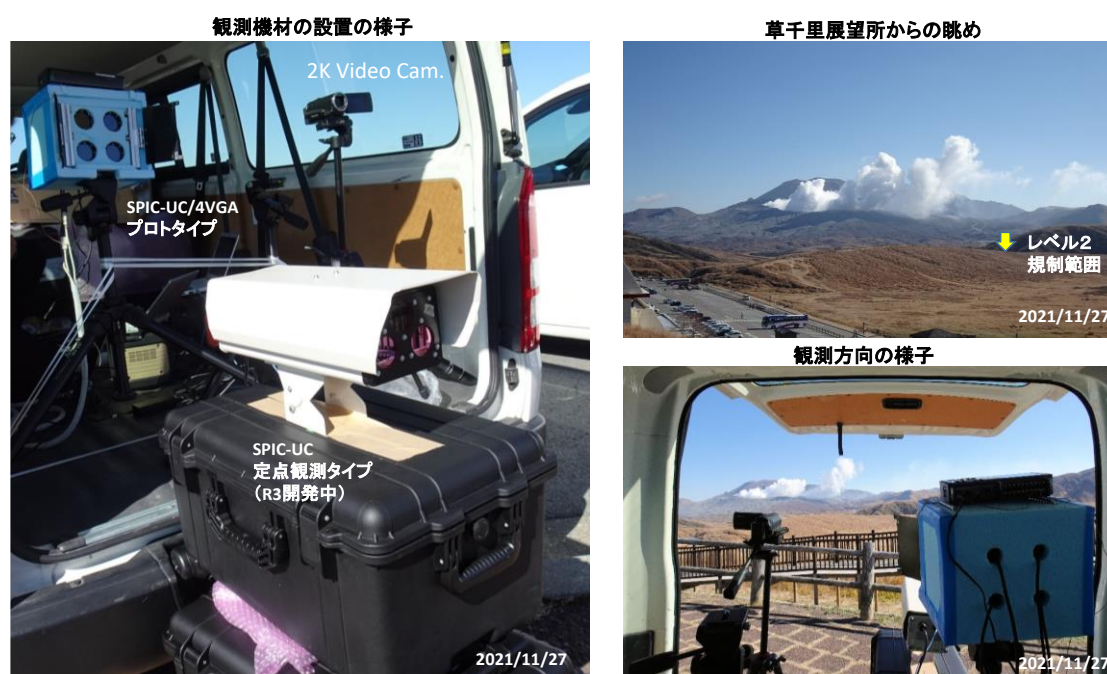
図 2-21 SPIC-UC/4VGA プロトタイプの阿蘇山中岳噴煙観測の 11 月 27 日の観測の様子（阿蘇山中岳の噴煙観測、2021 年 11 月 27 日）。中岳の西方 3.15km の草千里展望所より観測
