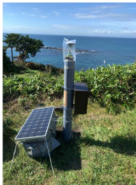
図 15 (左) 新規展開中の GNSS 観測点の外観 (アルトリ岬)。(右) 臨時観測の測位結果。
