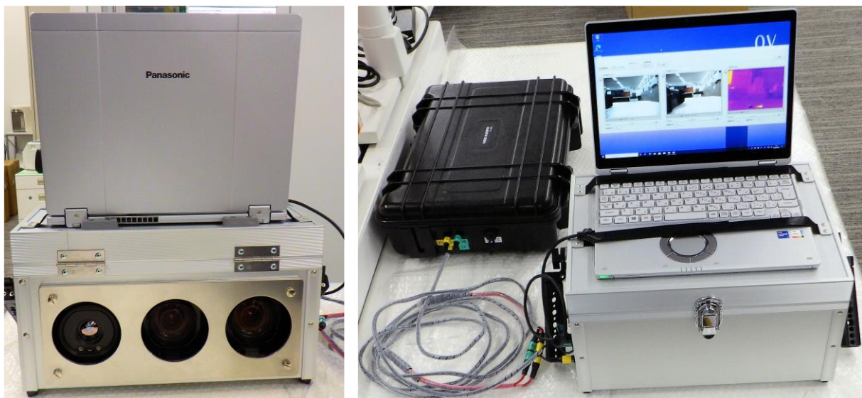
図 2-13 SPIC-SS フィールドタイプ（温度・地形計測）の完成写真と試験計測の様子
