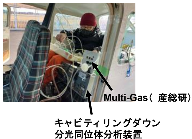
図 9 水蒸気同位体測定用のキャビティリングダウン分光同位体分析装置を搭載したセスナ機による桜島噴煙観測の様子（2022 年 2 月 21 日に鹿児島空港で撮影）。
