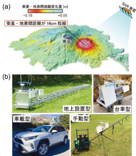
図1 (a) 衛星SAR（だいち2号のPALSAR-2）データを解析して得られた桜島の地殻変動。色は2015/8/10から2015/8/24の期間に生じた、衛星-地表間距離の変化を示します。 (b) 可搬型レーダー干渉計に関する4つの観測方式。観測場所の状況に適する方式を選択し、効率的に機動観測を実施します。
