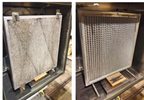
写真1 降灰試験後のプレフィルタ(左)と中性能フィルタ(右)
