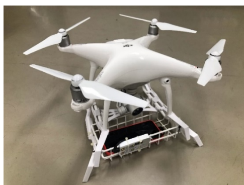
図 77. 遠隔データ回収装置を搭載したドローン。左 Mavic 2 Enterprise、右 Phantom 4。
