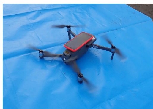
図 77. 遠隔データ回収装置を搭載したドローン。左 Mavic 2 Enterprise、右 Phantom 4。
