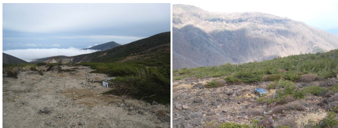
図21. 観測点の設置例。（左）蔵王御釜西観測点（TU.ZON）。（右）蔵王駒草平観測点（TU.ZKK）。本事業で新設した機動観測点では浅い穴底に地震計を設置した。そのため、周辺樹木の振動等に起因するノイズを避けるために樹木等の少ない地点を設置箇所として選定した。
