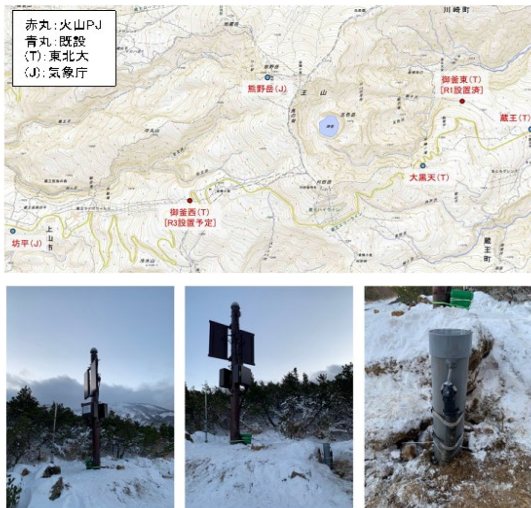
図 24. 蔵王山周辺の傾斜観測点分布（上）と令和元年度に設置した御釜東傾斜観測点竣工時の写真（下）。
