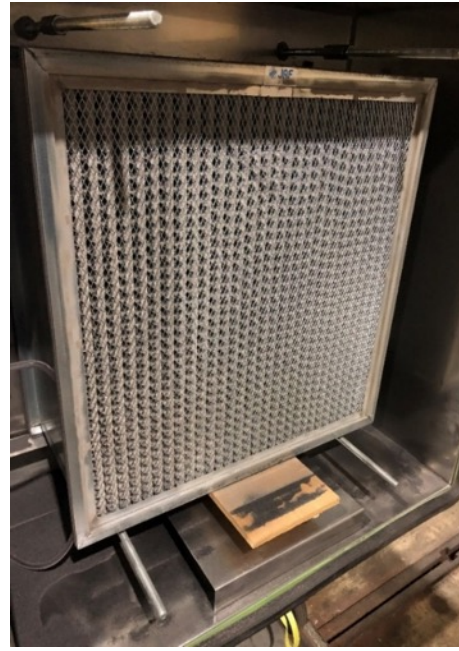
写真6 試験終了後の中性能フィルタ
