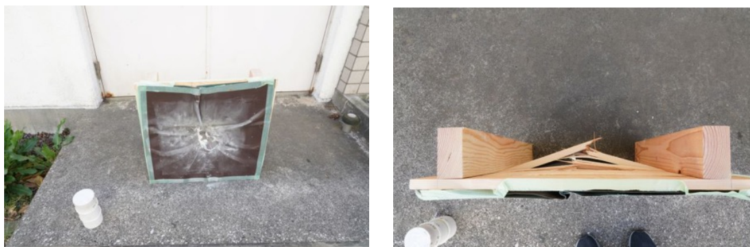
写真 20 軽石を置いた実験後の試験体 TK05 (左：正面、右：裏面)
