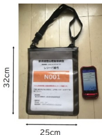
写真 17 登山道等に設置するレシーバー （スマートフォン、バッテリー、ケース）
