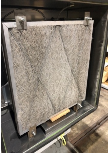
写真5 試験終了後のプレフィルタ
