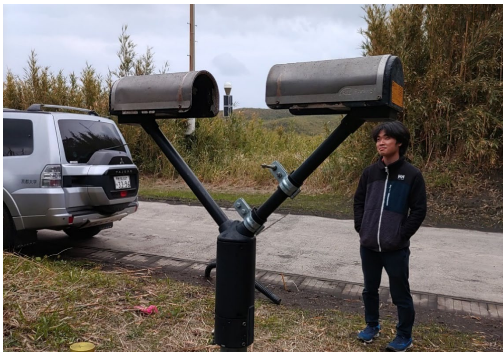
図 56 ディストロメータ（Parsivel 2 ）による火山灰のリアルタイム観測
