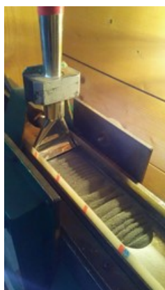
写真 3-2 本年度の降灰実験で使用されたダストフィーダーの仕組み。左) 火山灰の吸い込み口が上から伸びてきている (桜島火山灰を使用)。右) フィルター側から見た風路内への火山灰噴出口 (写真中央)。
