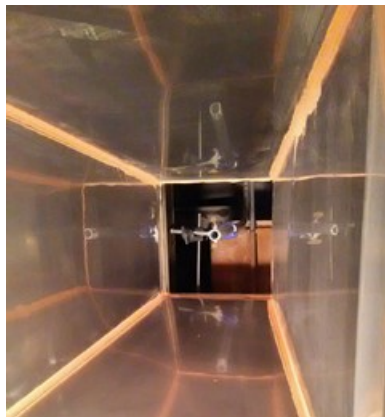
写真 3-2 本年度の降灰実験で使用されたダストフィーダーの仕組み。左) 火山灰の吸い込み口が上から伸びてきている (桜島火山灰を使用)。右) フィルター側から見た風路内への火山灰噴出口 (写真中央)。
