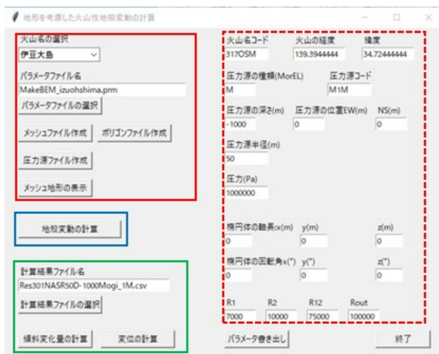
図 1 3 火山周辺の地殻変動計算システムの操作用GUIの画面。赤枠は山体地形や圧力源のメッシュを作成するための機能、青枠は地殻変動の計算を行う機能、緑枠は計算結果を観測点ごとの観測量に変換する機能の部分それぞれ示している。赤点線枠内は必要なパラメータの設定を行う部分を示している。
