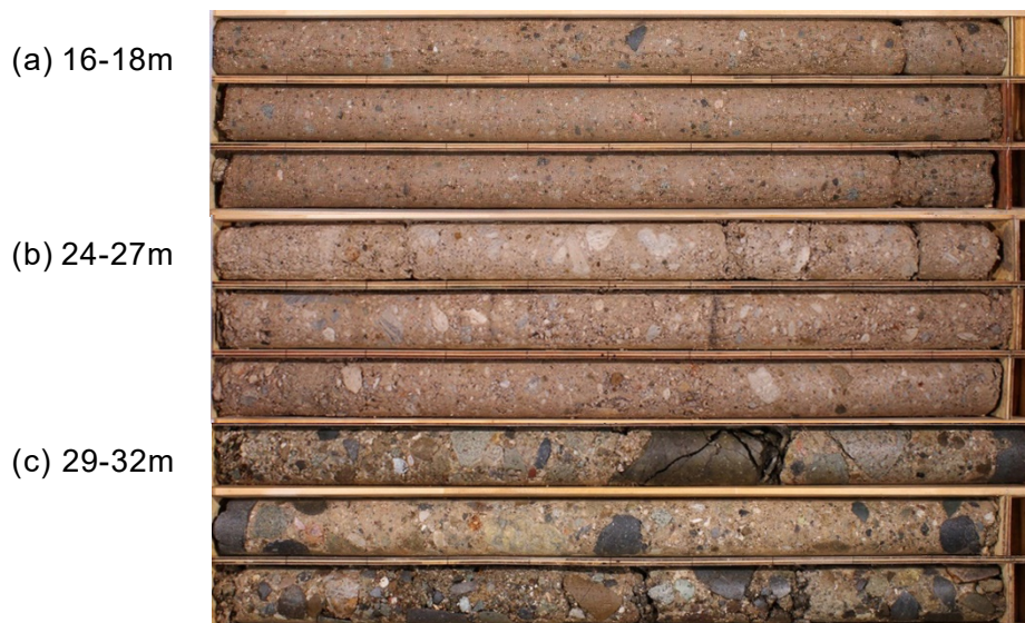
図 3 3. 代表的なコア試料の写真（各写真の左側・上側が上位）。(a) 深度 16.0-18.0 m。凝灰角礫岩層。斑晶に乏しい白色軽石を含む。(b) 深度 24.0-27.0 m。凝灰角礫岩層。洞爺火砕流堆積物ユニット 6 42) に相当する。灰色軽石・縞状軽石が目立つ。(c) 深度 29.0-32.0 m。洞爺火砕流堆積物ユニット 5-6 間のラグ角礫岩層。
