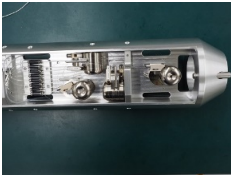
写真 4 筐体内部，センサ組み込み状況
