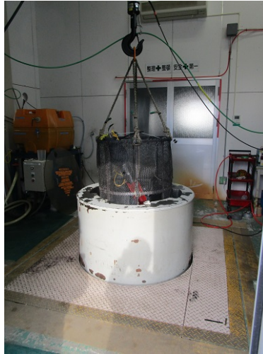
写真2 筐体の圧力試験時，実験後圧力試験容器から取り出すところ
