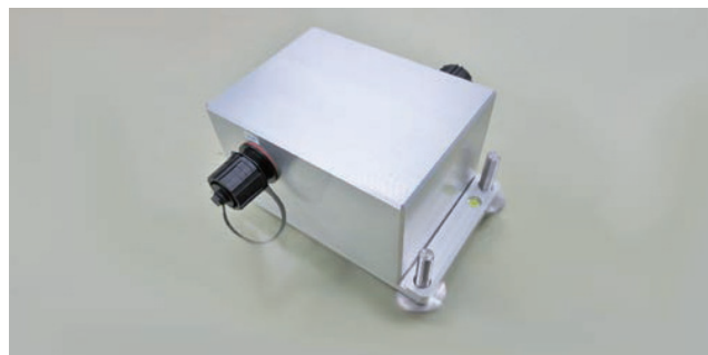
図3 光センサーシステムの3成分センサー格納筐体 (サイズは12 cm × 15 cm × 9 cm)
