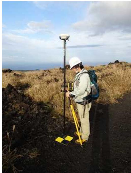
図 8 基準点のネットワーク型RTK-GPS測位の状況
