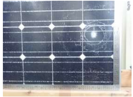
(左) 太陽光パネルの噴石に対する耐衝撃性能試験の実験装置。(右) 衝撃後の円状にひび割れた（カバーガラスが割れた）状態。
