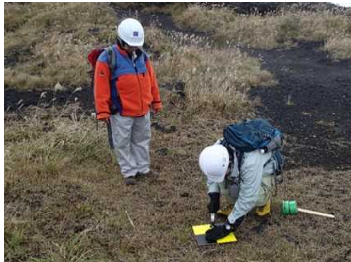
図 6 対空標識の設置状況
