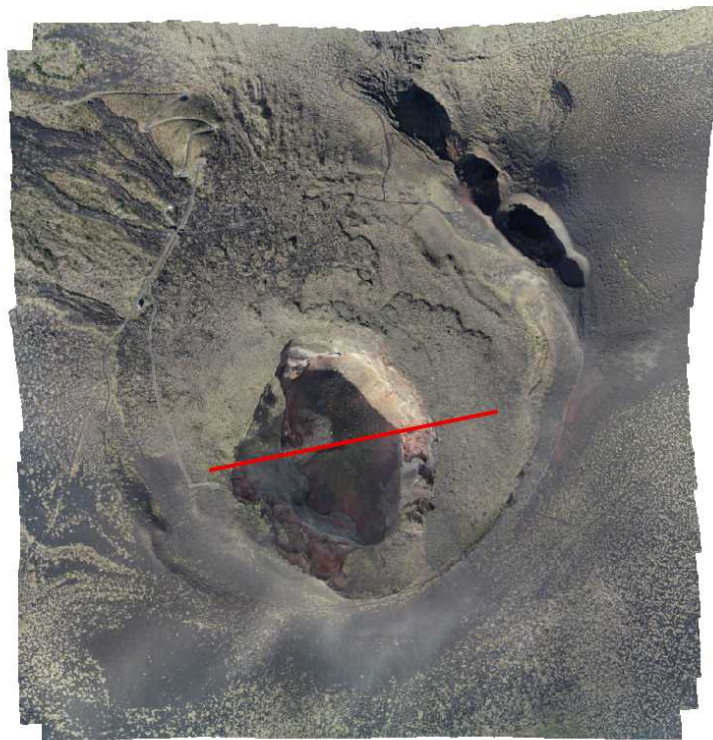
図 12 三原山火口DEMデータの断面線(赤線)位置図
