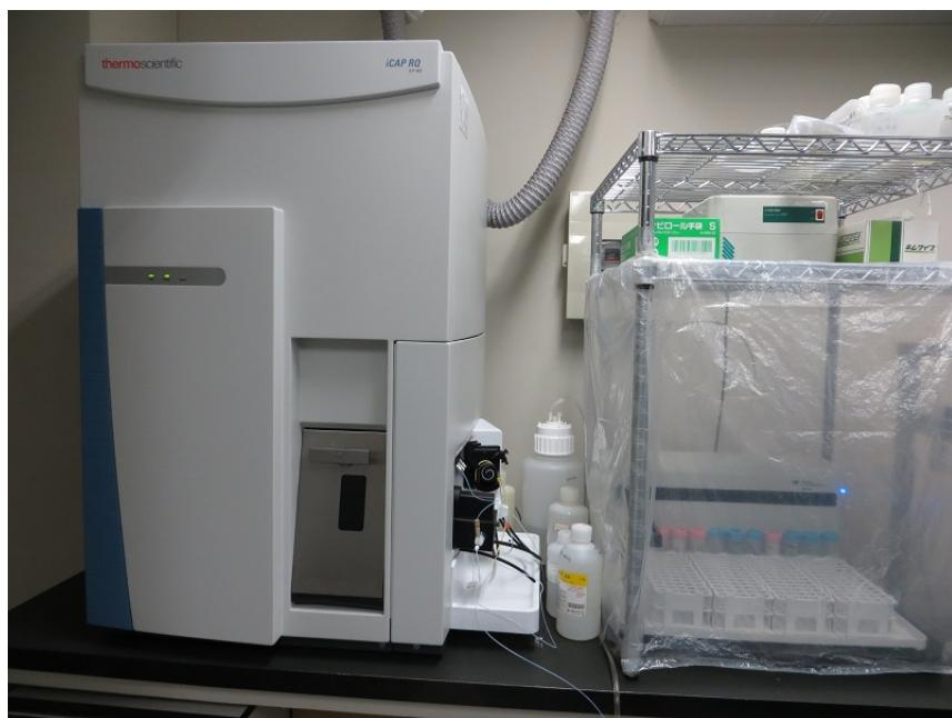
図83 マグマ変遷解析センターに設置された ICP-MS (iCAP RQ)。
