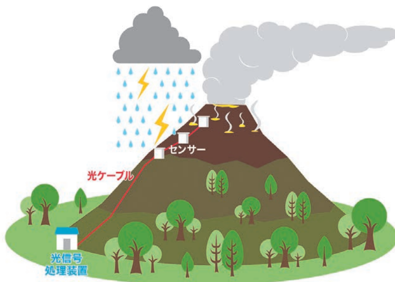
図1 光センサーシステムによる火山観測概念図
