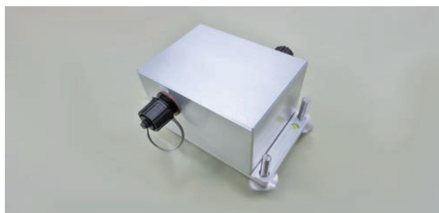
図3 光センサーシステムの3成分センサー格納筐体 （大きさは12 cm × 15 cm × 9 cm）
