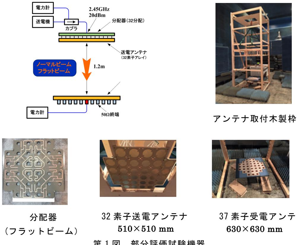
ビームパターンはノーマルビームとフラットビームを評価対象とした。下図に試作したレクテナ整流器の RF/DC 変換効率(実測)を示す。入力電力によって RF/DC 変換効率が大きく変化するため、ビームは極力受電アンテナ面で均一な電力密度となるフラットパターンが望まれる。
