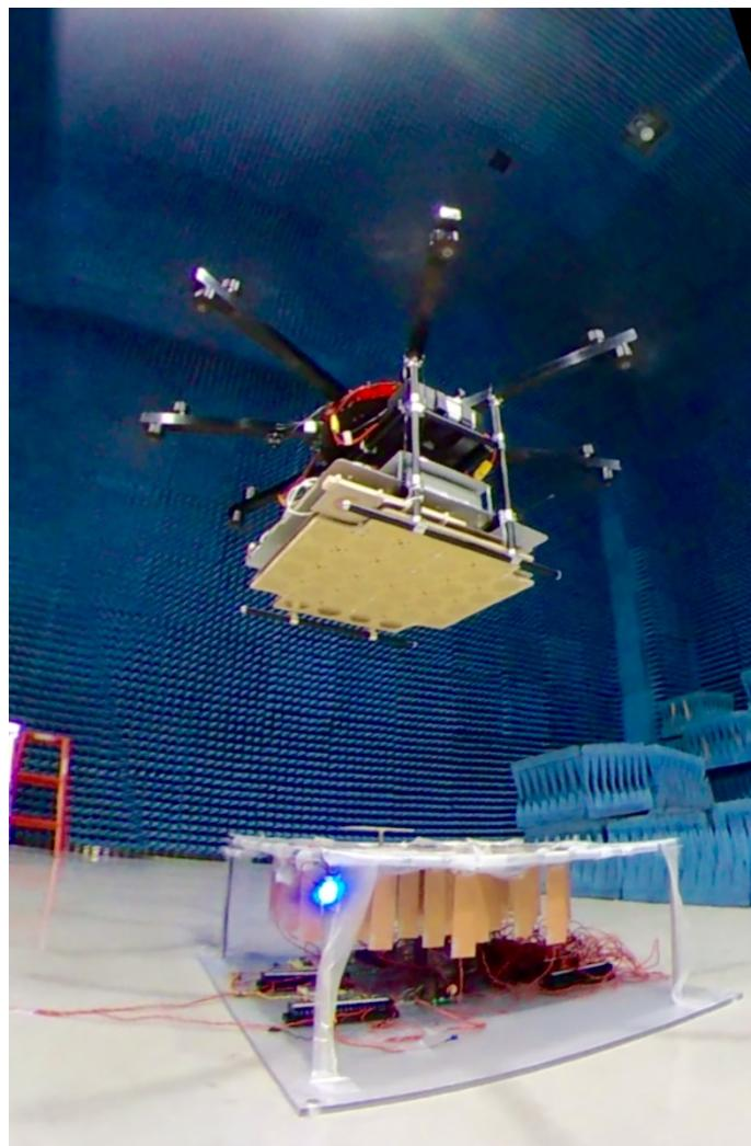
大型の無人航空機（ドローン）による、空中マイクロ波送電実験風景。
