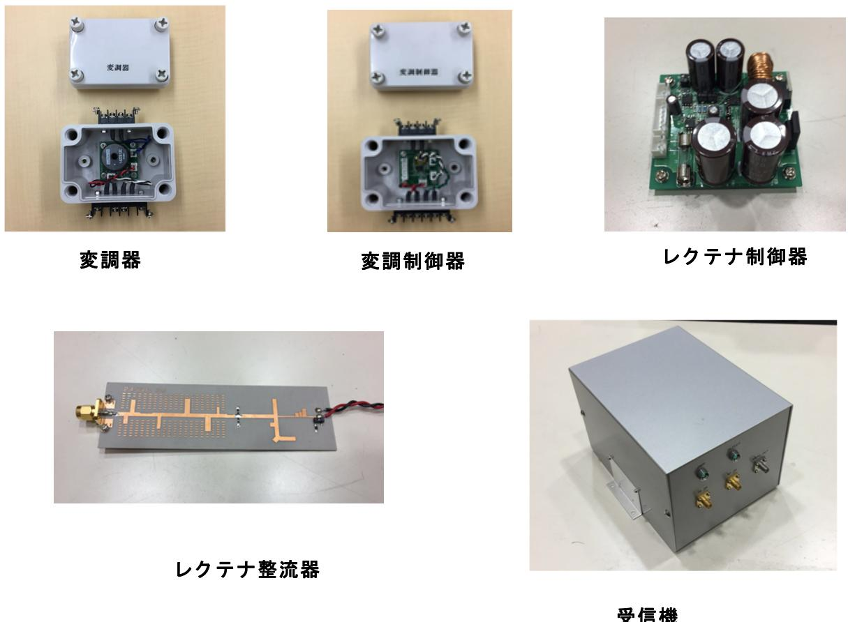
第 11 図 通信機能付レクテナの構成機器
