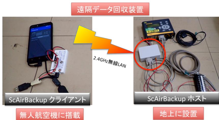
第 8 図 改良した遠隔データ回収装置。
