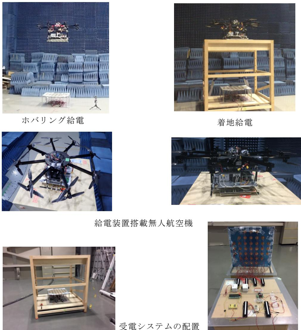
第7図 空中マイクロ波給電実験に使用した装置
