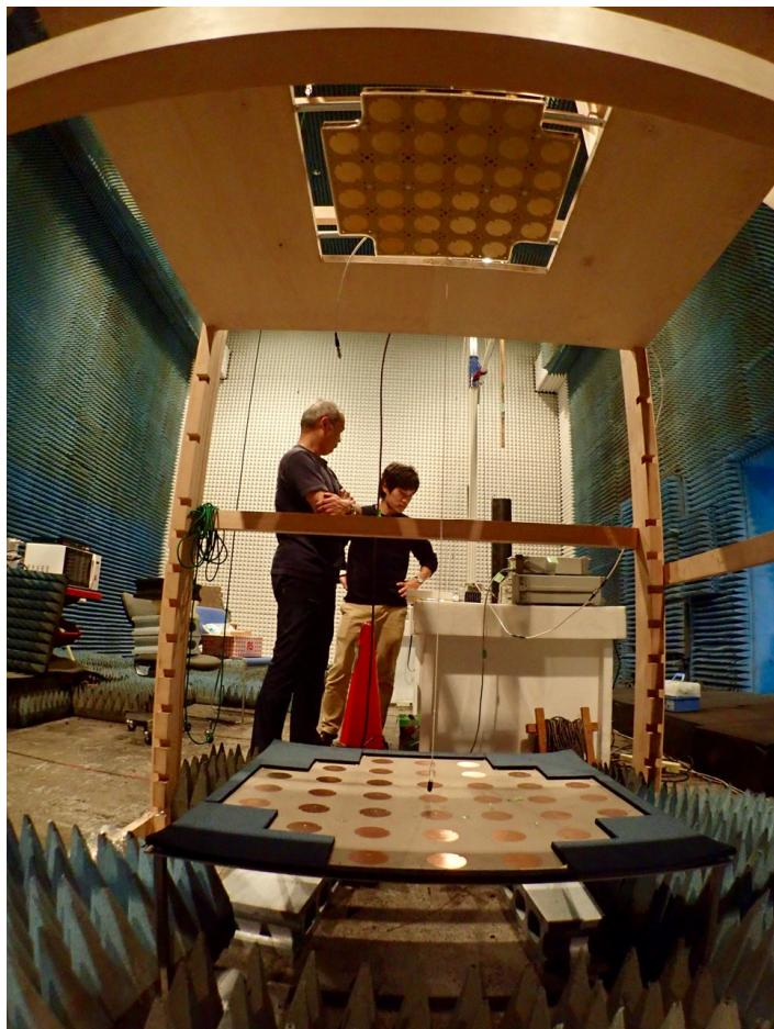
京都大学の大型電波暗室内で実施しているマイクロ波送電実験風景。
