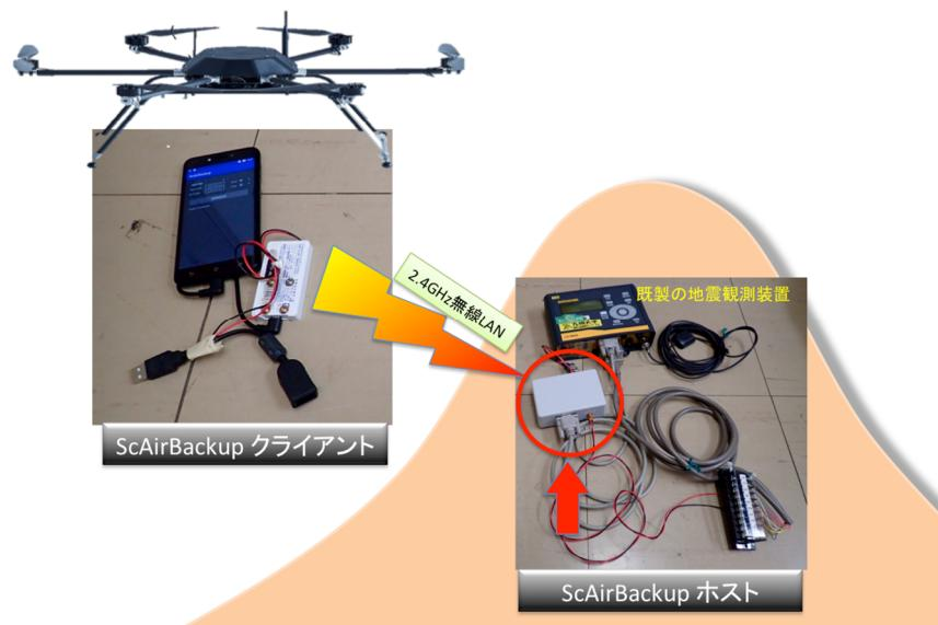
試作・改良した遠隔データ回収装置ホスト(右)とクライアント(左)。前者は地上設置し、後者は無人航空機に搭載する。ホストの上空にクライアントを搭載した無人航空機が接近すると、蓄積されていたデータは無線 LAN を使用してクライアントに回収される。両者の距離は 30m 離れても回収可能である。
