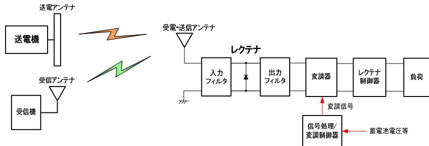
第 10 図 無線試験による通信機能の確認
