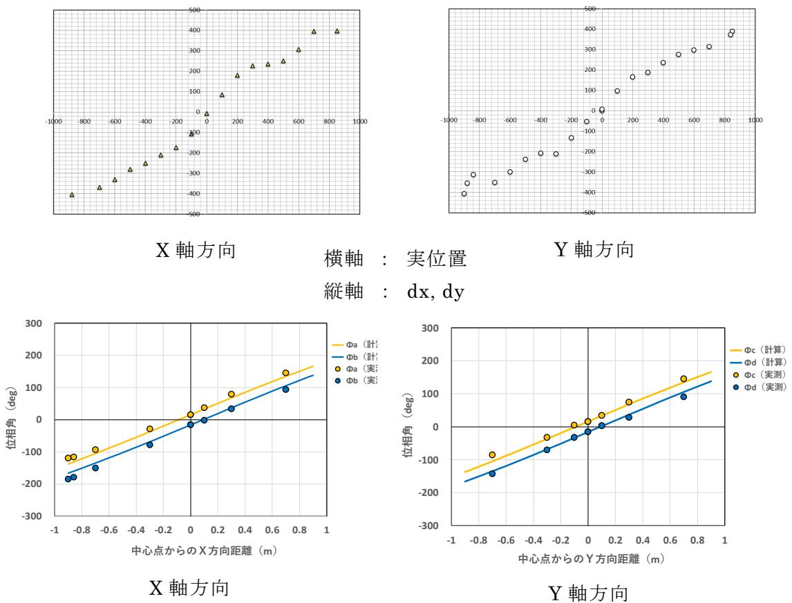
第 15 図 高さ 3m における水平位置の実測値と計算値の比較
