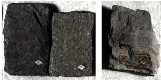
写真 12. バルク試料 (約  $90\times60\text{mm}$ )。左から、玄武岩、輝石安山岩、黒雲母流紋岩 ( $R/G/B=635/551/471\text{nm}$ )。
