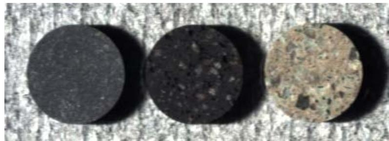
写真 11. 整形試料 ( $\phi 16\text{mm}$ ,  $h=7\text{mm}$ )。左から、玄武岩、安山岩、流紋岩 ( $R/G/B=635/551/471\text{nm}$ )。
