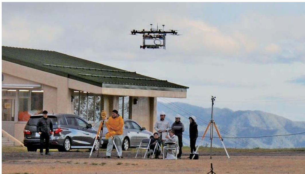
写真1 16 翅大型無人航空機の飛行実験。10kg の荷物を積載して7 分間飛行することができます。飛行時間を延ばすために、積載機材の軽量化も不可欠です。
