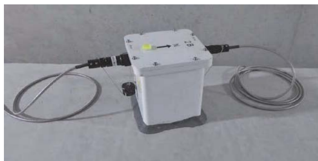
写真1 光センサーシステムのセンサー部
