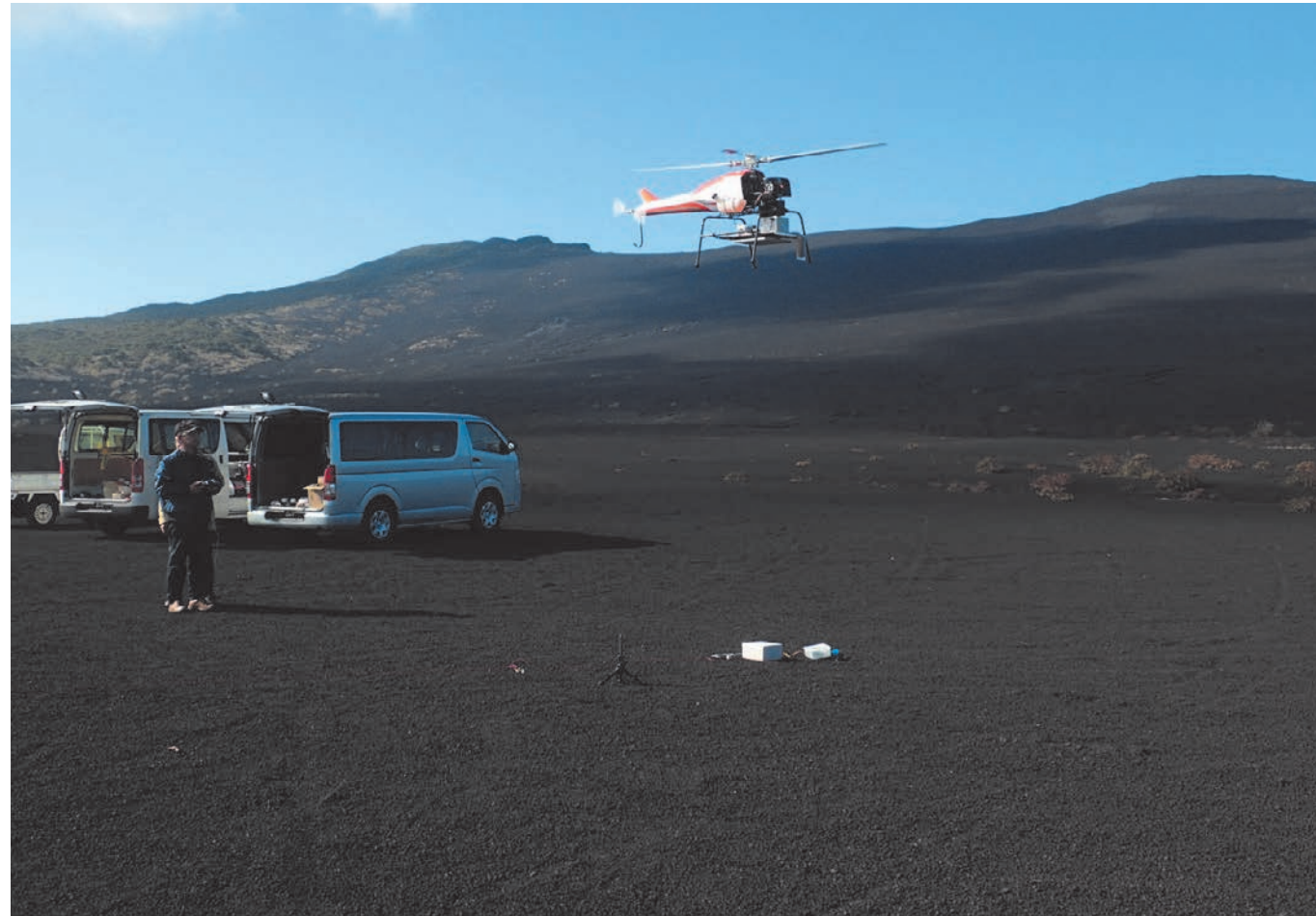
写真1 伊豆大島における空中マイクロ波送受電およびデータ回収実験
