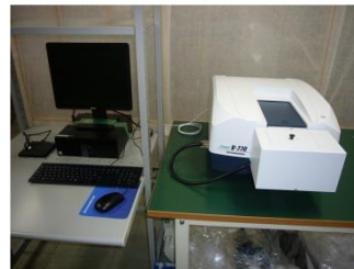
H28年導入の装置(紫外可視近赤外, 顕微紫外可視近赤外分光装置等)を活用しスペクトル計測を実施
