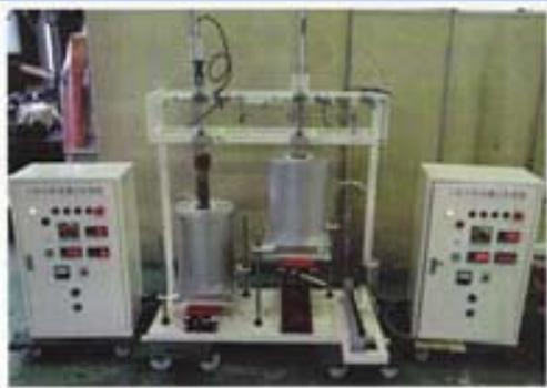
水熱合成実験装置, HPテクノスより
