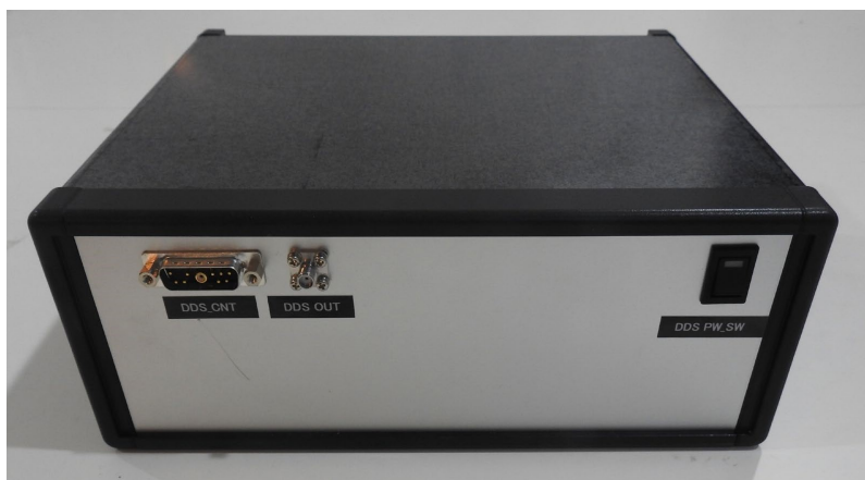
図 1-1 DDS 信号発生器の外観写真
