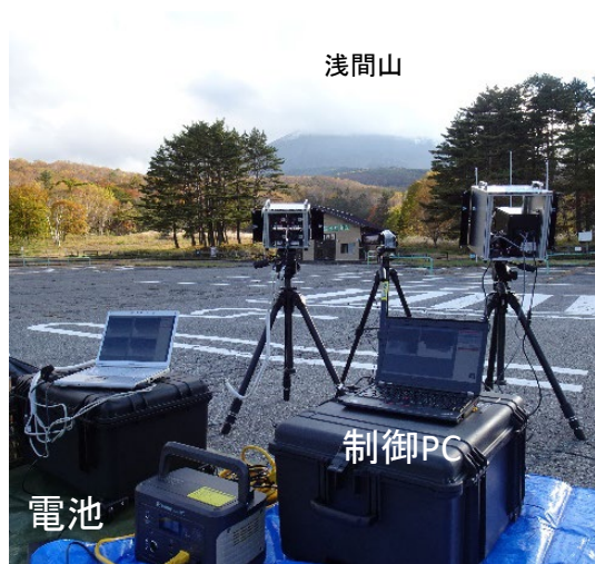
図 2-13 浅間山火山試験観測での SPIC-UC (4VGA)、SPIC-C (LWIR) プロトタイプ設置の様子
