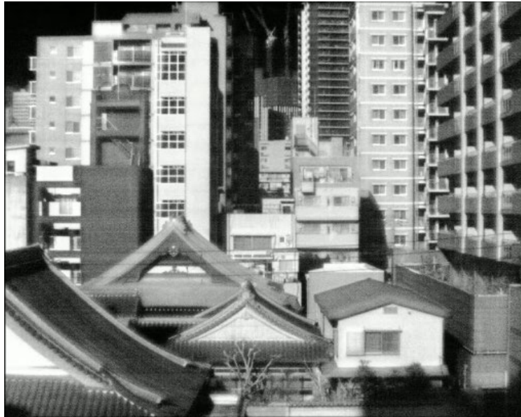
図 2-10 SPIC-C プロトタイプの冷却型 MWIR カメラ試験観測画像（温度レンジ-20～300℃）
