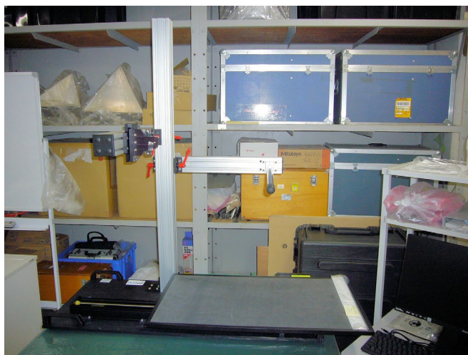
図 2-32 完成した大型試料スキャンステージの外観写真
