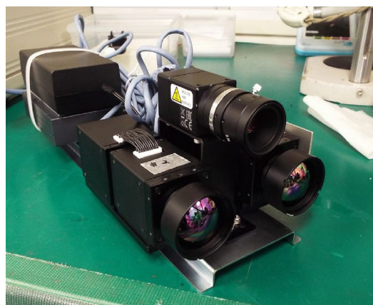
図 2-5 非冷却型赤外カメラ (SPIC-UC) フィールドタイプの完成写真 (外観と格納されたカメラ)
