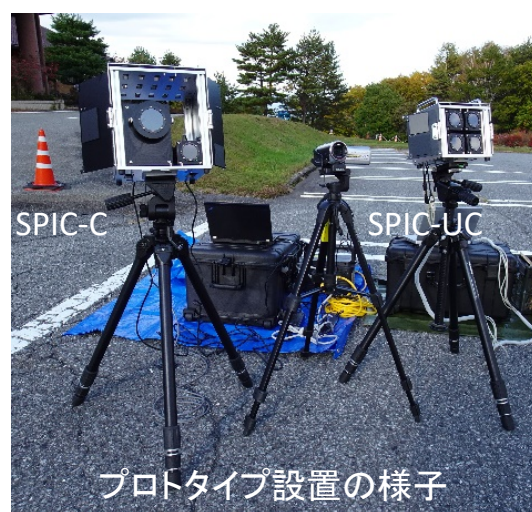
図 2-13 浅間山火山試験観測での SPIC-UC (4VGA)、SPIC-C (LWIR) プロトタイプ設置の様子
