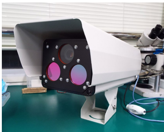
図 2-5 非冷却型赤外カメラ (SPIC-UC) フィールドタイプの完成写真 (外観と格納されたカメラ)
