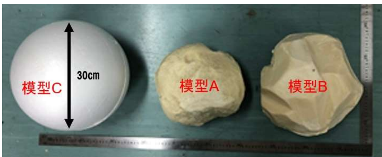
図 95 落下実験に用いた噴石模型。
