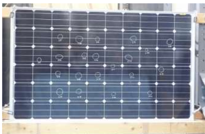
図 93 衝突試験に用いた太陽光パネル。噴石を衝突させてもカバーガラスが割れなかった場合、位置を変えて（白丸で示している中央部に衝突させた）衝突試験を行った。
