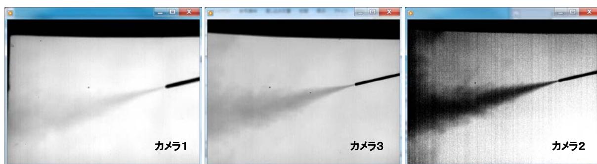
図 9. 60℃の平面黒体を背景として HFC152a ガスをカメラ 1、2、3 で観測した結果
