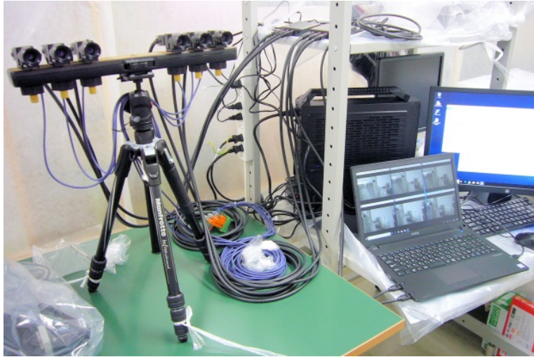
写真 3. SPIC-SS のカメラ（6 台の Full HDD）を近接させ並列に設置した様子
