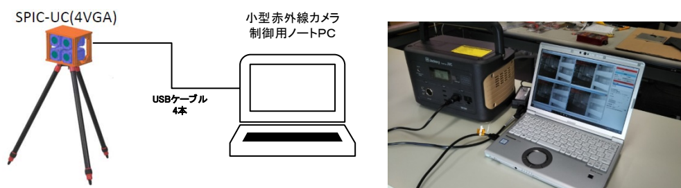
図 32. SPIC-UC(4VGA)の試験画像取得時の機器構成。接続概略(左)、制御用PCとポータブル電源(右)
