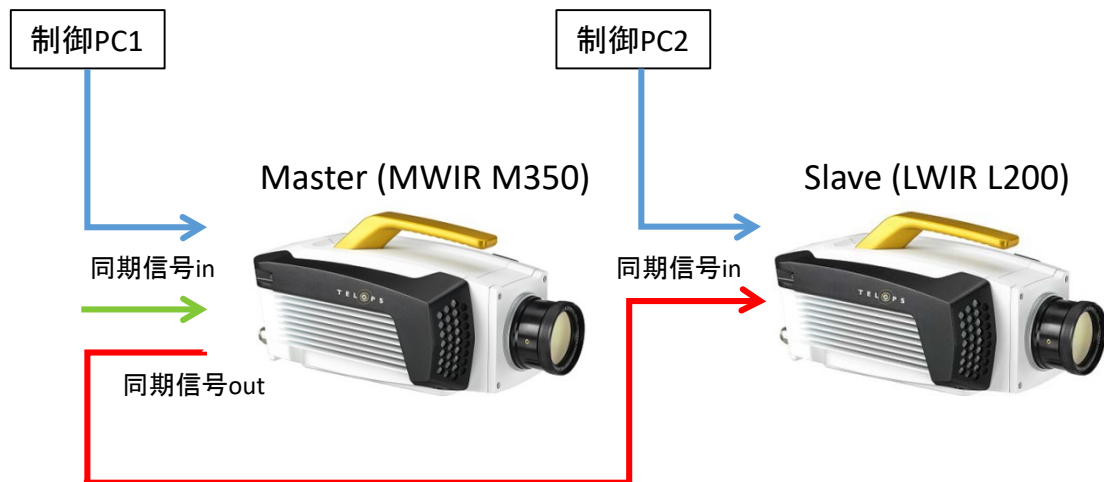
図 15. 同期信号 (TTL) による SPIC-C(MWIR)カメラセンサーヘッドと SPIC-C(LWIR)カメラセンサーヘッドの同期計測機構の実現
