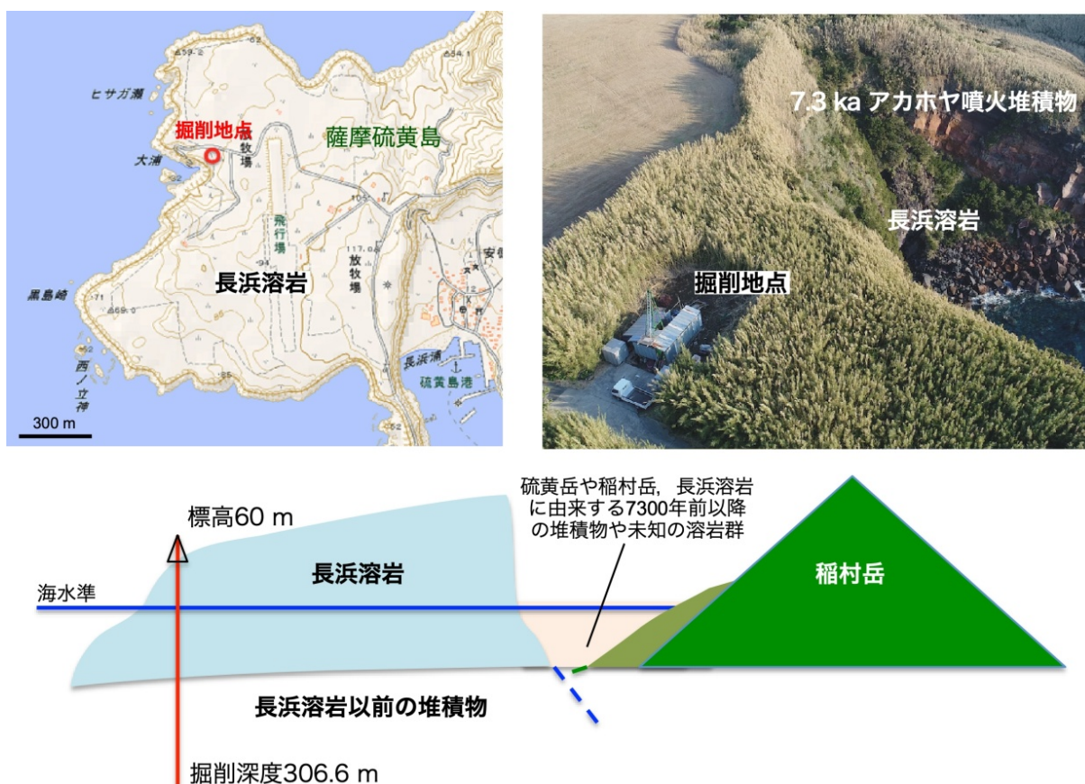
図 6 9 ボーリング掘削地点とその空撮画像（上）。薩摩硫黄島西側、長浜溶岩およびカルデラ内の模式断面図（下）。
