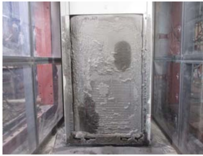
図 24 フィンに付着した火山灰(左)と 圧縮機に堆積した火山灰(右) 室外機の吸気ならびに排気の風速を、携帯用サーミスタ風速計を用いて計測した。室外機の稼働中降灰の実験 2、4 ならびに 5 を対象に、降灰深と風速の関係を室外機正面、側面(図 9)ならびにファン上方について図 25 に示す。
