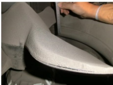
図 16 ファンへの堆積と起動の状況(実験 1.50mm)
